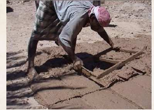
(صورة ٥٦) كيفية صناعة المدر (الطوب اللين)
