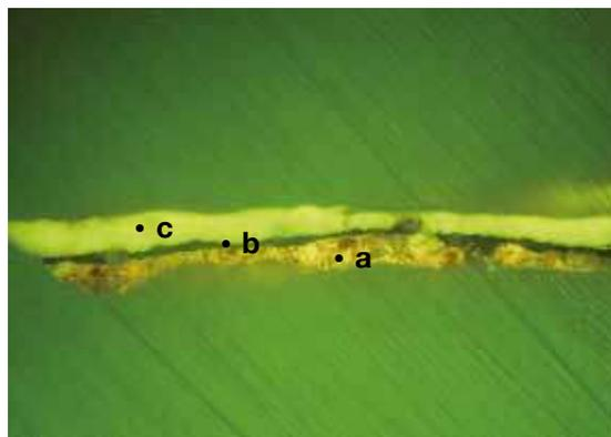
**Fig. 30:** Microfotografia del campione Y-9 in luce ultravioletta al fine di evidenziare la presenza di materiali fluorescenti ai raggi UV.
