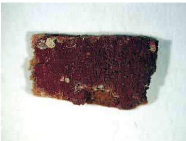
*Fig. 1.* Fotografia allo stereomicroscopio del frammento di pellicola pittorica Y4 di colore rosso, prelevato dalla seconda navata dell’ala nord della moschea al-Jāmi‘ al-Kabīr di Ṣan‘ā.
