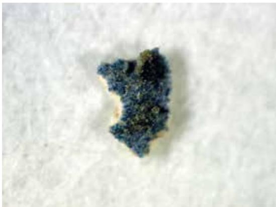
**Fig. 11.** Fotografia allo stereomicroscopio del frammento di pellicola pittorica Y6 di colore azzurro, prelevato dalla seconda navata dell'ala nord (soppalco) della moschea al-Jāmi' al-Kabīr di Ṣan'ā'.
