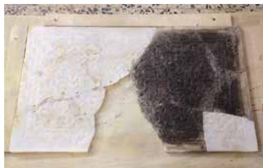
*Fig. 25, 26.* Particolare delle lastre di alabastro durante una fase intermedia di pulitura.
